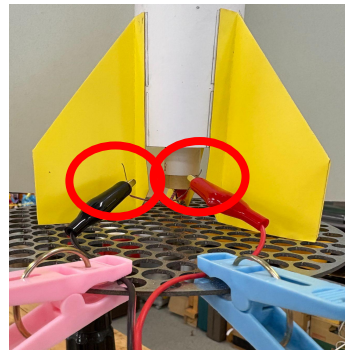
配線とミノムシクリップは空中に浮くように固定
